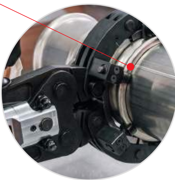
Guide sopra la sede di contenimento dell'o-ring Guides over the o-ring groove
