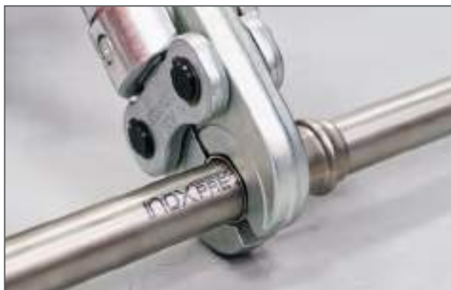
Assemblaggio attraverso pressatura / Making the press connection
