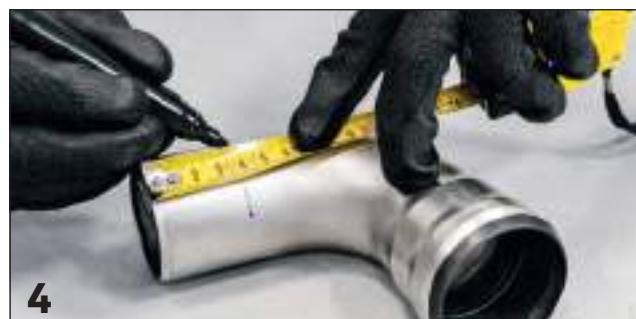
4 Marcatura quota d'innesto / Marking the insertion's depth
